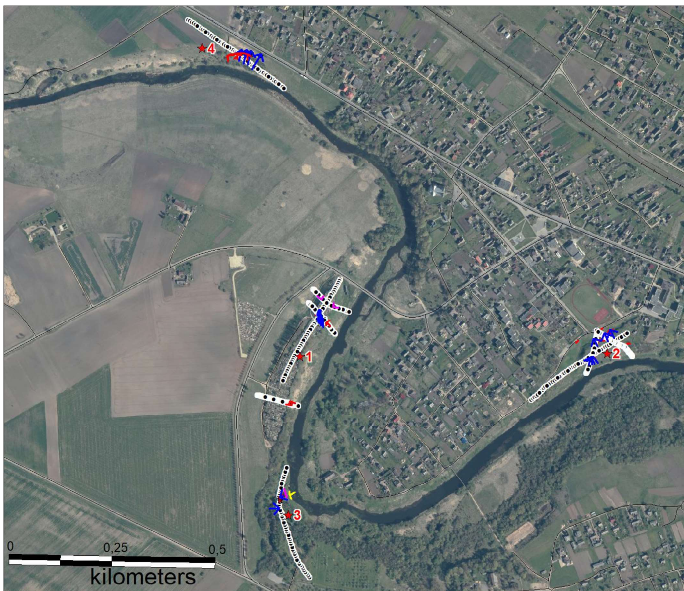
4 pav. Geofizinių (elektrotomografinių ET - juoda spalva ir georadaro GPR – mėlyna spalva) tyrimų vietos: 1 - I piliakalnyje; 2 - II piliakalnyje; 3 - Jurakalnio atragyje; 4 – nuošliaužoje Vėntos upės slėnio šlaite ties kelio Nr. 155 22-uoju km.
