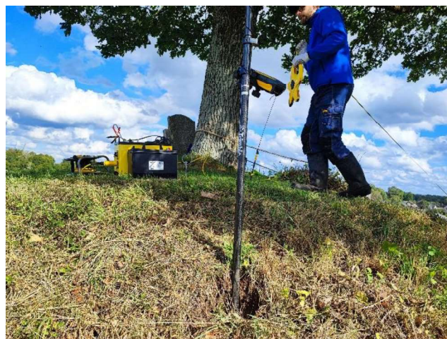
5, 6 nuotr. Piliakalnio kapinių teritorijoje šalia ištiesto ET profilio-2 atsekamas nuošliaužos atitrūkimo 22 m ilgio ir 2-3 – 5-8 cm pločio lineamentas (ET profilyje anomalinis 34-38 m intervalas, žr. 9 pav.).
